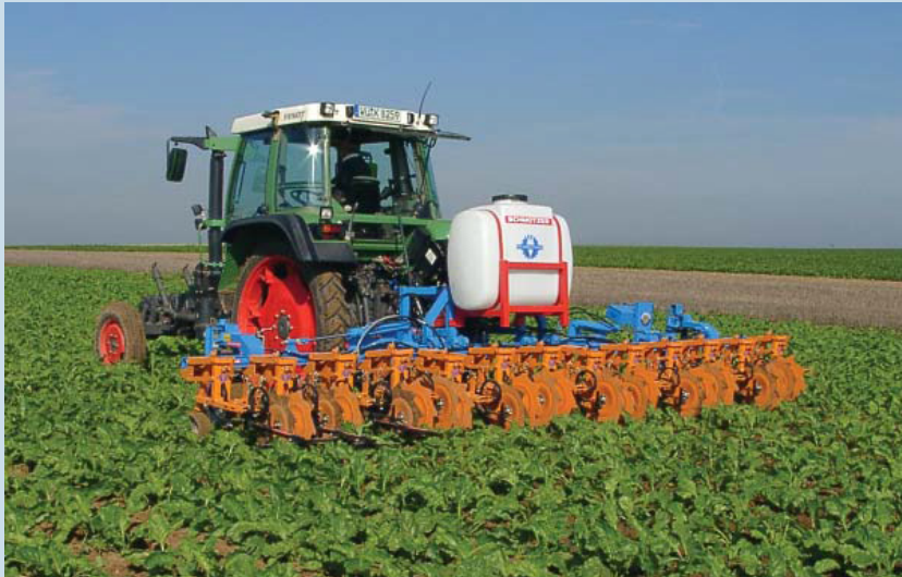
Bandspritz-Hack-Kombination in Zuckerrübe
