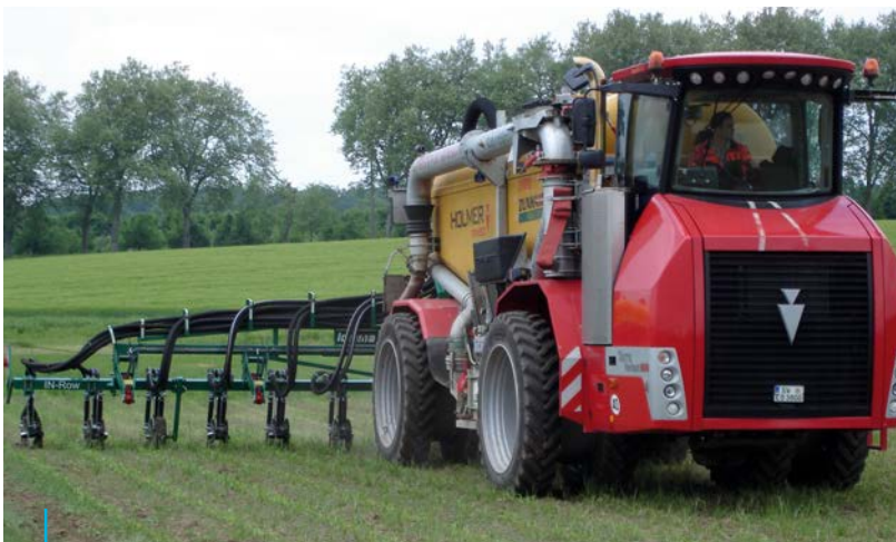
Scheibenschlitzgerät für die Gülleausbringung zwischen den Reihen
