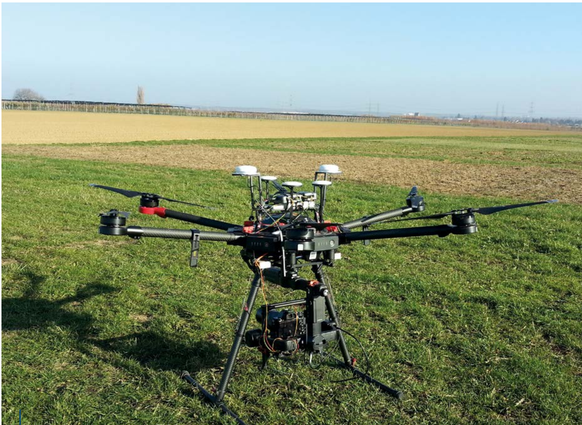
Im Projekt CropWatch eingesetzter Oktokopter
