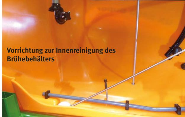
Moderne Geräte verfügen über eine spezielle Vorrichtung zur Reinigung des Brühebehälters. Diese besteht aus einem rotierenden Sprühkopf und zusätzlichen Düsen, die sich über eine separate Druckleitung zuschalten lassen. Damit ist eine Reinigung des Brühebehälters mit Wasser aus dem Frischwasserbehälter möglich. Bei Altgeräten ohne diese Technik gestaltet sich die Behälterreinigung viel aufwändiger. Dann muss der Brühebehälter mehrmals mit Wasser aufgefüllt und ausgespült werden.
