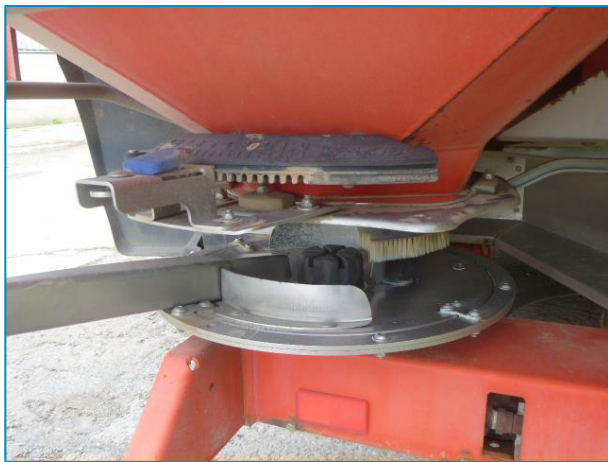
Streuscheibe mit verstellbaren Streuschaufeln
