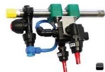
Kein Absteigen vom Schlepper mehr notwendig. Diese Schaltung ist nachrüstbar. Auf Knopfdruck kann man zwischen Normal- und Randdüse umschalten. Das kompakte 3-Wege-Ventil wird am Spritzrohr fixiert und die Flüssigkeit am äußersten Ende des Gestänges entnommen.
