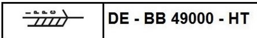
Abbildung 8: Muster einer ISPM-15 Markierung mit Hitzebehandlung für Brandenburger Betriebe
