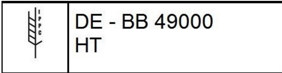
Abbildung 6: Muster einer ISPM-15 Markierung mit Hitzebehandlung für Brandenburger Betriebe
