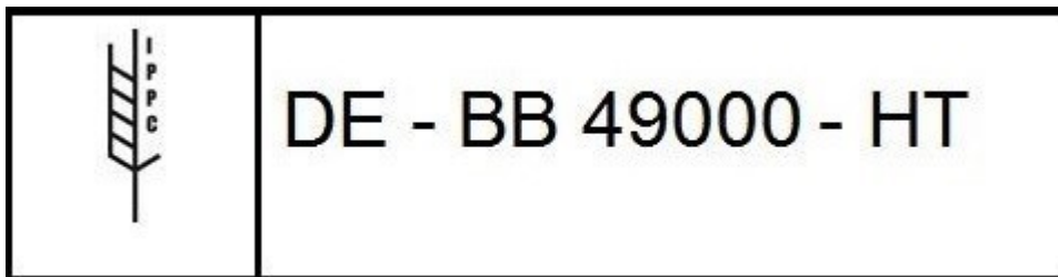
Abbildung 7: Muster einer ISPM-15 Markierung mit Hitzebehandlung für Brandenburger Betriebe
