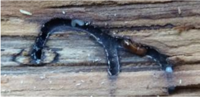
Abbildung 8: Bohrgang mit Käfer und Larven, © M. Noack, LELF
