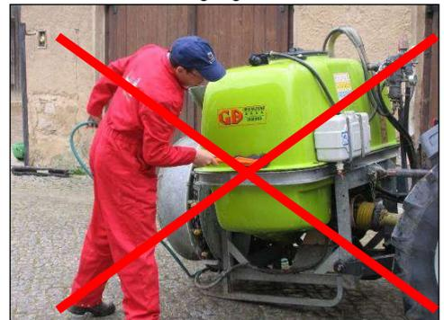
Keine Reinigung auf versiegelten Fläche mit Ablauf in die Kanalisation
