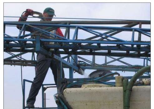
Außenreinigung mittels Hochdruckreiniger
