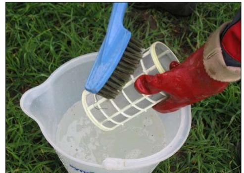
Ausbau und Reinigung von Düsen und Filtern
