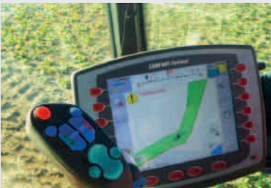
GPS mit automatischer Teilbreitenabschaltung
